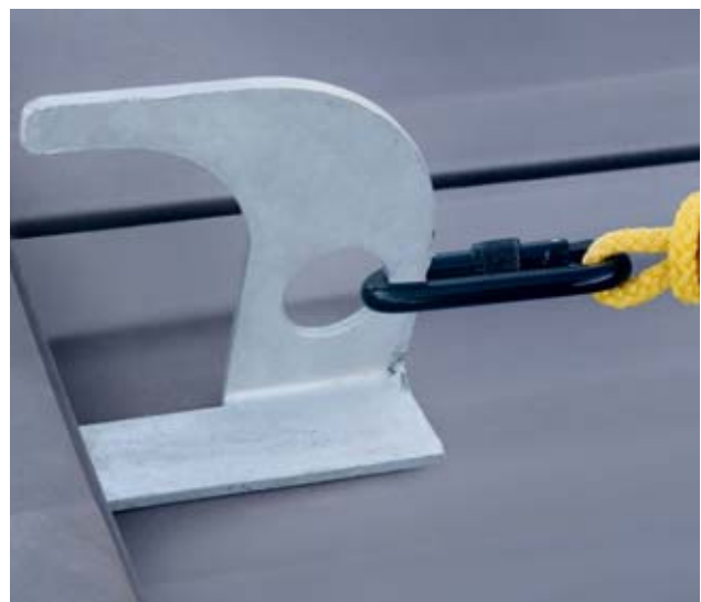
4 Sicherung gegen Absturz: Der Sicherheitsdachhaken für die Dachleiter – mind. gem. EN 795 oder EN 517 - ist so ausgebildet, dass er auch als Anschlagpunkt für das Sicherungsseil dient.
